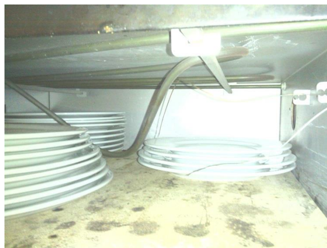
Four à pizza : résistance chauffante déformée et plus fonctionnelle
